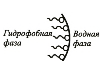
Рис. 14.3. Схема действия ПАВ на границе гидрофильной и гидрофобной фаз
