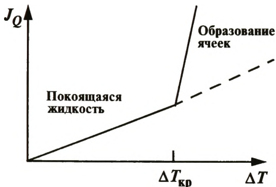
Рис. 18.6. Зависимость общего потока теплоты J_Q , передаваемого вертикально в системе, изображенной на рис. 18.5, от разности температур \Delta T нижнего и верхнего слоев жидкости
