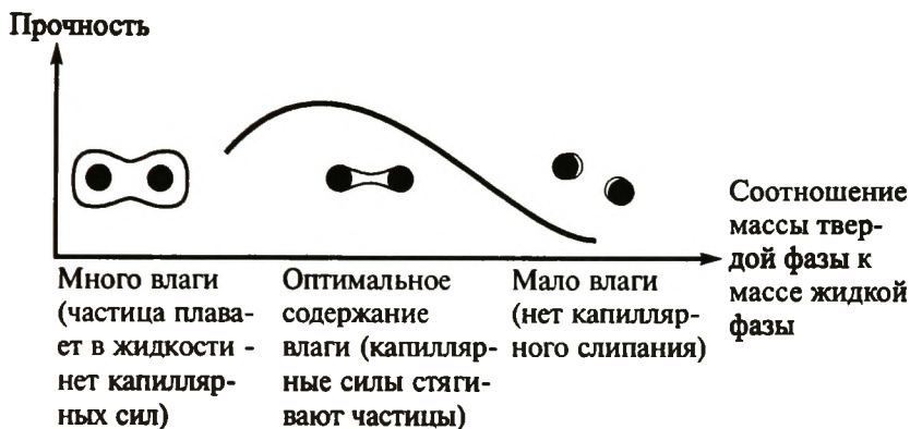
Рис. 14.2. Влияние капиллярных сил на прочность тела, состоящего из дисперсных частиц
